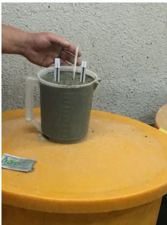
รูปที่ 18 การทดสอบตามมาตรฐาน JIS สำหรับคอนกรีตที่ผลิตจากมวลรวมรีไซเคิล ณ SAEZONE Plant
