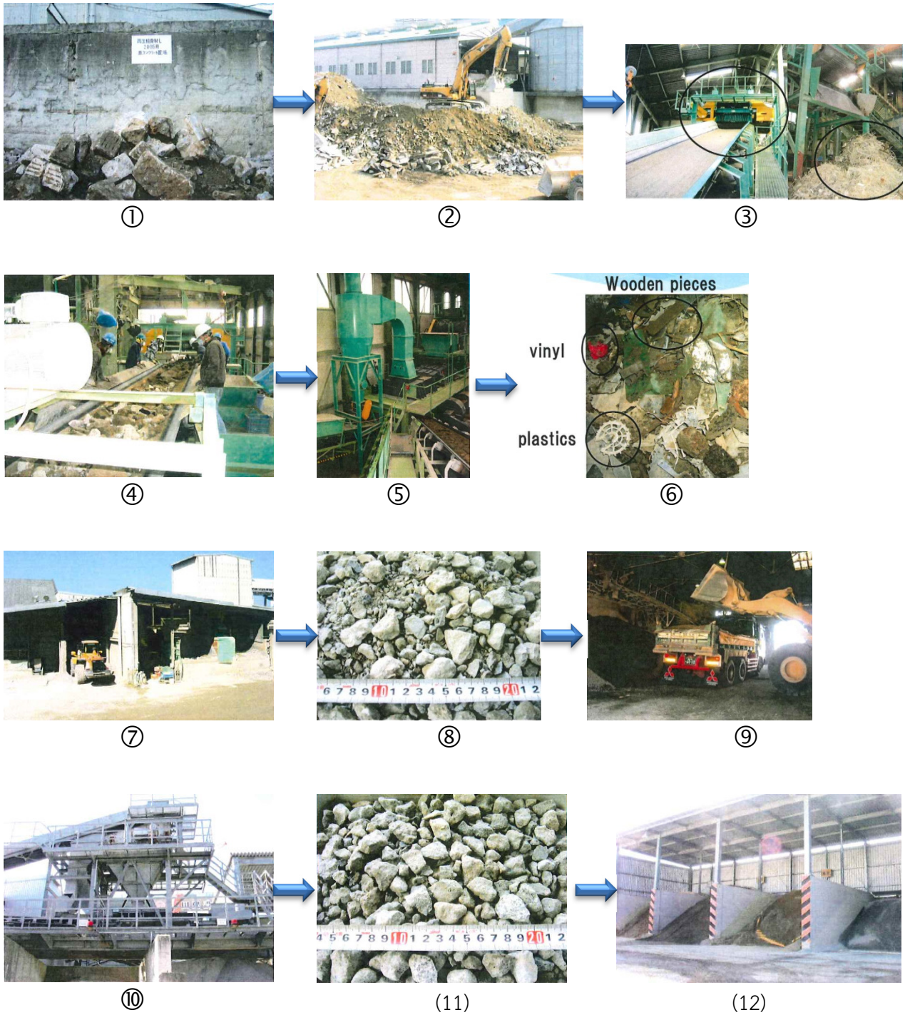
รูปที่ 8 Process of manufacture recycled coarse aggregate L2005 Higuchil Sangyo Co., Ltd. [5]
