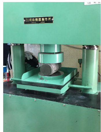
รูปที่ 18 การทดสอบตามมาตรฐาน JIS สำหรับคอนกรีตที่ผลิตจากมวลรวมรีไซเคิล ณ SAEZONE Plant
