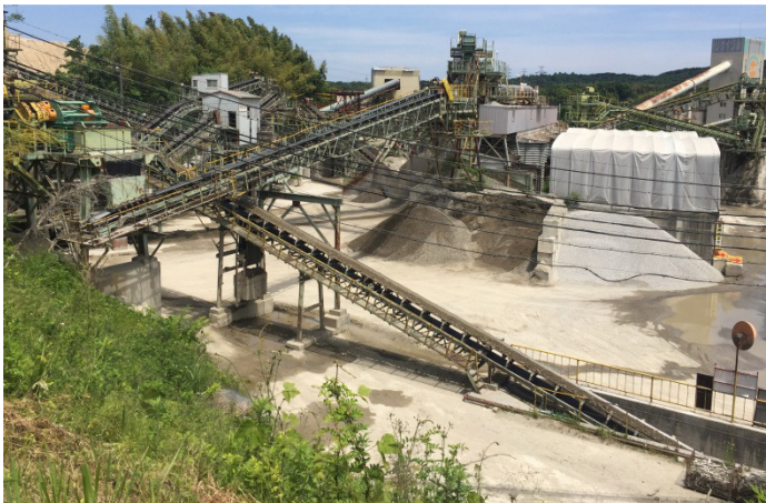
รูปที่ 12 โรงงานของ SAEZONE, Inc. ผลิตรวมรีไซเคิลโดยวิธี Gravity Concentration
